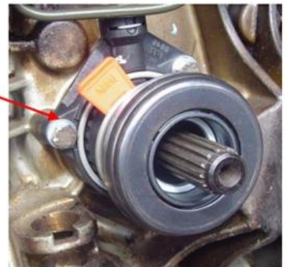
RETIRAR TRABA DE SEGURIDAD
