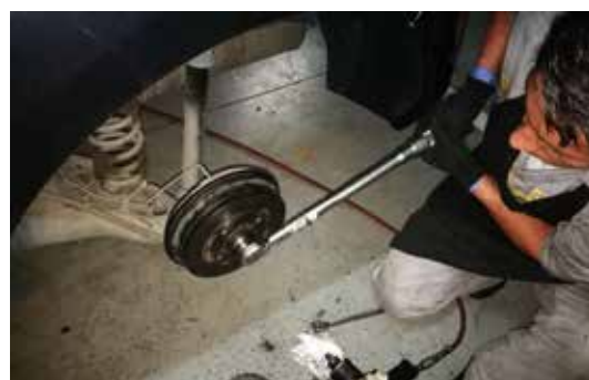
Ejemplo: Garantizando el torque correcto según fabricante con llave manual de torsión (torquímetro)
